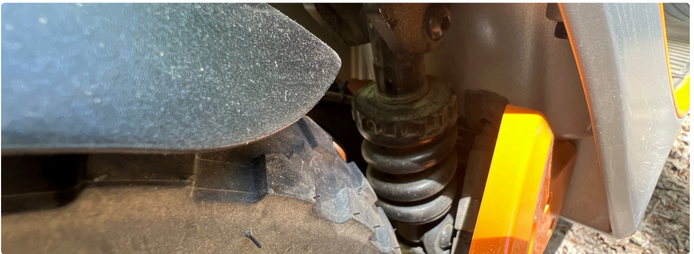
Hinten: zentraler Stoßdämpfer (Coil-Over) am 12x3.00-Reifen
