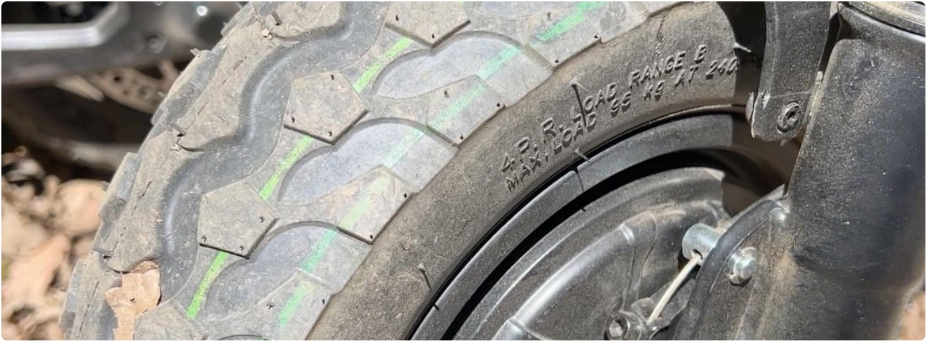
12-Zoll-Reifen mit grobem Offroad-Profil – schlauchlos, luftgefüllt
