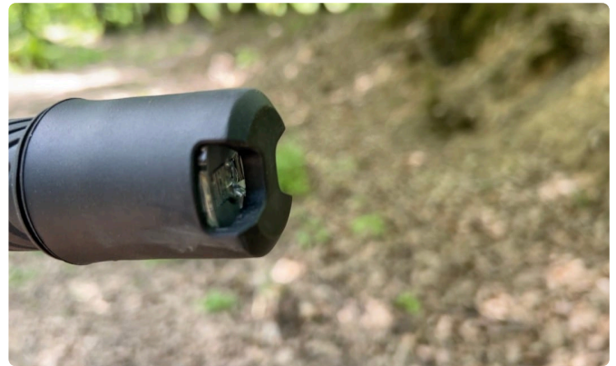
Der Blinker besteht aus zwei orangen LEDs – je einer am Ende des linken (mit Gummi-Schutzkappe) und des rechten Lenkergriffs.
