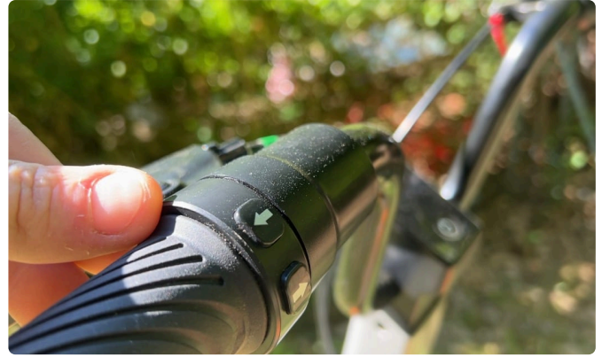
Bei Tageslicht: der LED-Frontscheinwerfer (links, in der Neigung verstellbar) und die beiden Blinker-Tasten am linken Lenkergriff (rechts).
