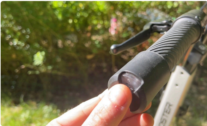
Der Blinker besteht aus zwei orangen LEDs – je einer am Ende des linken (mit Gummi-Schutzkappe) und des rechten Lenkergriffs.
