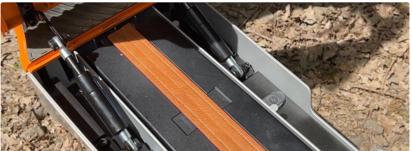
Das Fach unter dem Trittbrett, geöffnet – zwei Gasdruckdämpfer halten den Deckel, in der Mitte der Wechselakku mit Ledergriff.
