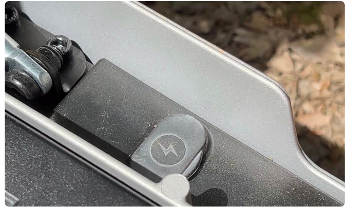
Links der Akku mit Typenschild und das Zündschloss (die eigentliche Wegfahrsperr), rechts die Ladebuchse – beides sitzt geschützt im Fach.
