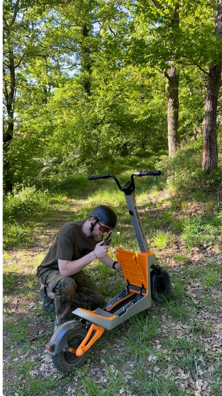
Akku-Wechsel im Feld – Klappe auf, Wechsel-Akku rein, in unter 30 Sekunden
